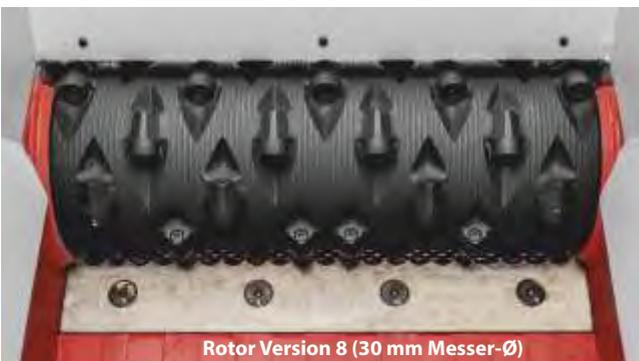
Die konkav gefrästen Rundschneidkronen ermöglichen einen sehr hohen Durchsatz bei geringem Kraftaufwand durch einen effizienten Scherenschnitt. Die Messerhalter sind auf dem profilierten Rotor geschraubt oder geschweißt.
