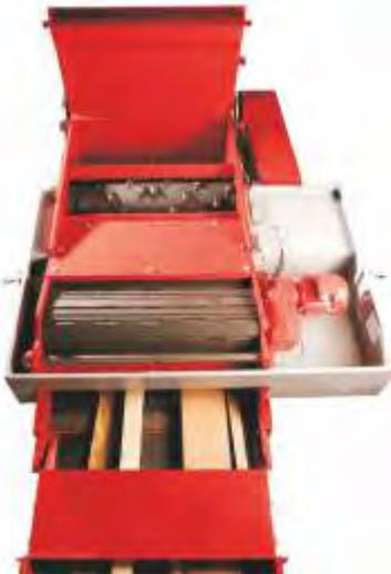
Für die Zerkleinerung von langen und kurzen Resthölzern, Spanplatten, Paketen und Streifen können die Horizontalzerkleinerer der Baureihe RHZ plus eingesetzt werden.
