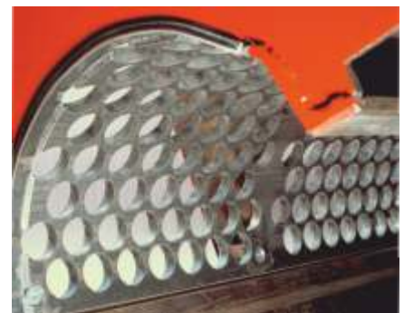
Der benötigte Zerkleinerungsfaktor des Aufgabematerials kann durch variabel anpassbare Siebe mit entsprechender Sieblochung bestimmt werden
