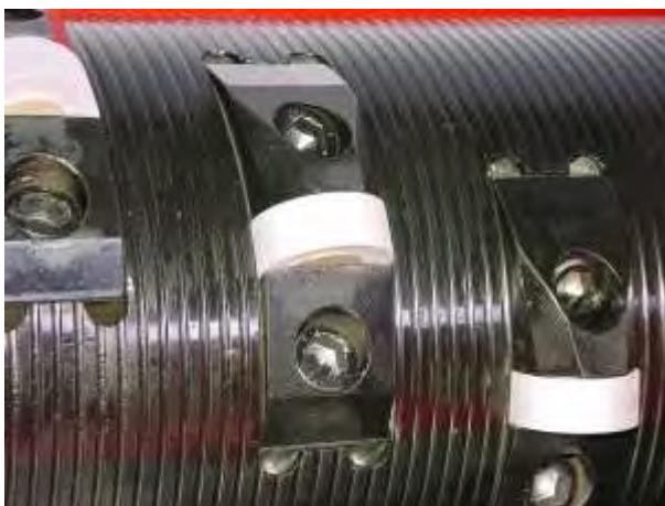
Detail geschraubter Spannkeil
