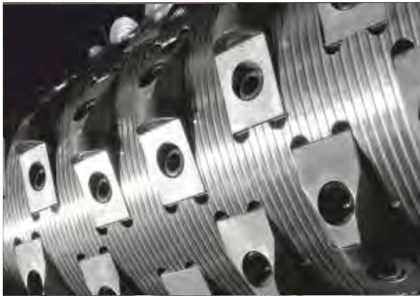
Rotor-Ø 354 mm mit drei Messerreihen
