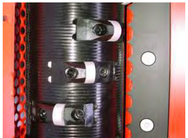
Detail geschraubter Messerhalter
