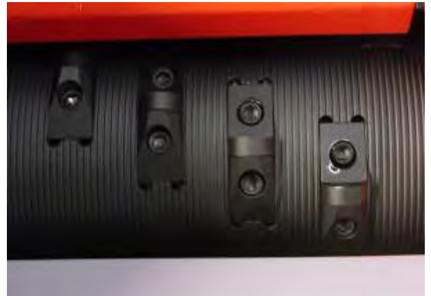
Rotor-Ø 252 mm mit einer Messerreihe
