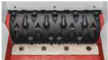
Rotor-Version 8 (30 mm Messer-Ø)
