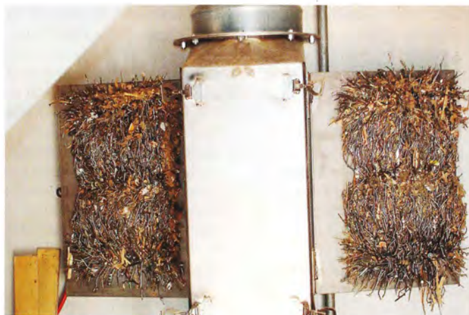
Abscheidung von Metallteilen per Rohrmagnet (oben)
