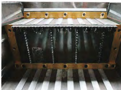
Abscheidung von Metallteilen per Rohrmagnet (oben)
